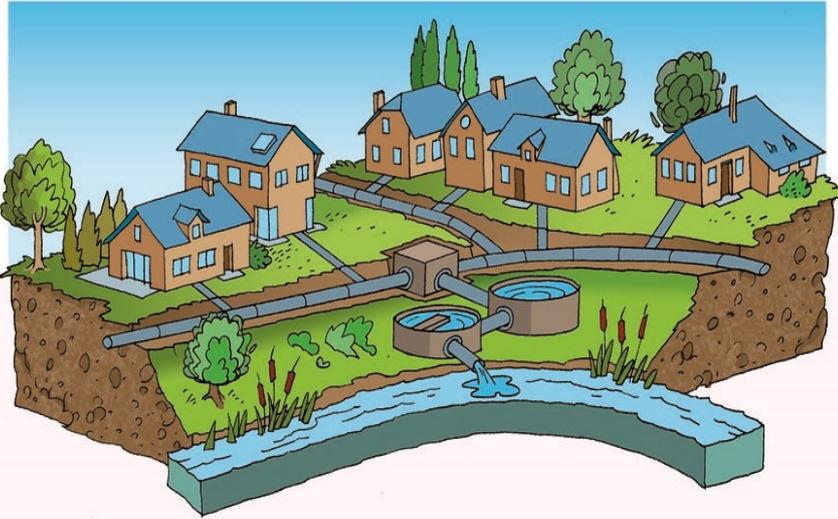
Die von den OAA's verwalteten Kläranlagen sind für die Abwasserklärung in kollektiven Klärzonen verantwortlich. Die Abwässer werden über das Kanalsystem und die Sammelrohre zu den Kläranlagen geleitet. In kollektiven Klärzonen ist der **Anschluss** an die Kanalisation **Pflicht!**
